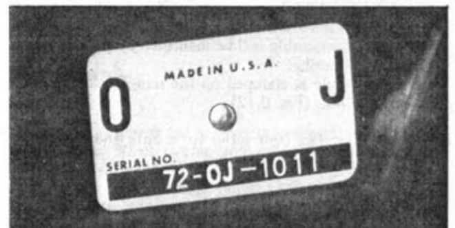
Fig. 0-9—Turbo Hydra-Matic (375 &amp; 400 Incl. Toronado) Serial Number Plate
